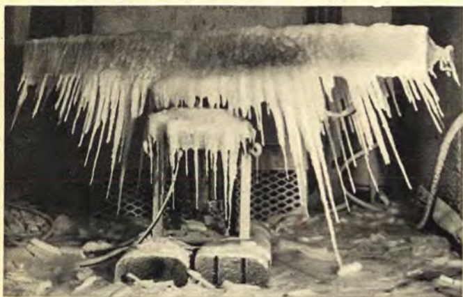
Bild 1. Vereiste Radarantenne in der Kältekammer, in der arktische Klimabedingungen simuliert und verschiedene Methoden erprobt wurden
